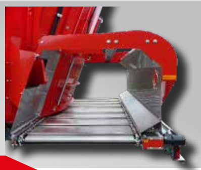
Tapis col de cygne droit ou gauche pour distribuer dans les auges.
