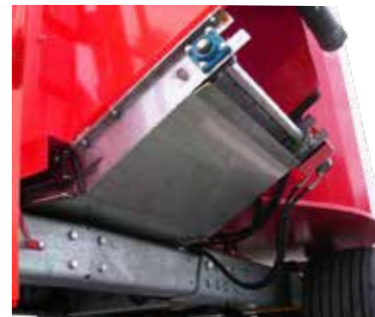
Tapis col de cygne droit ou gauche pour distribuer dans les auges.
