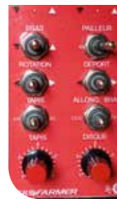
COMMANDE ÉLECTRIQUE AVEC RÉGULATEUR
