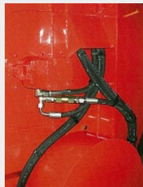
Entraînement du démêleur par moteur hydraulique renforcé (de série P280 et SP280)
