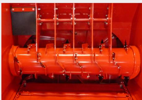
Démêleur tous fourrages doigts fixes entraînement mécanique (de série P300 GP et SP300 GP)
