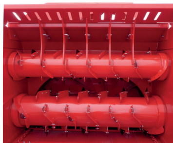
Double démêleurs Ø620+Ø460 à doigts fixes Brins courts, tous fourrages (entraînement mécanique)
