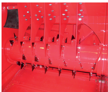
Simple Démêleur Ø500 à doigts fixes Tous fourrages (entraînement mécanique)
